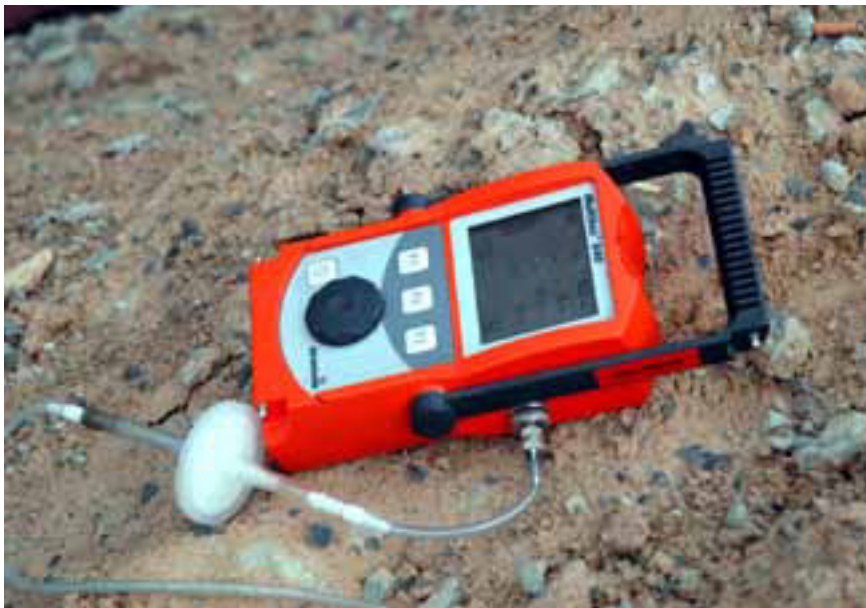
Der Umgang mit einem Gasspürgerät für die Ortung von Gasleckagen und die Bestimmung der Konzentration des Gases sollte von Feuerwehrleuten beherrscht werden.
