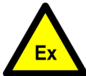
Abb. 7: Kennzeichnung explosionsgefährdeter Bereiche
